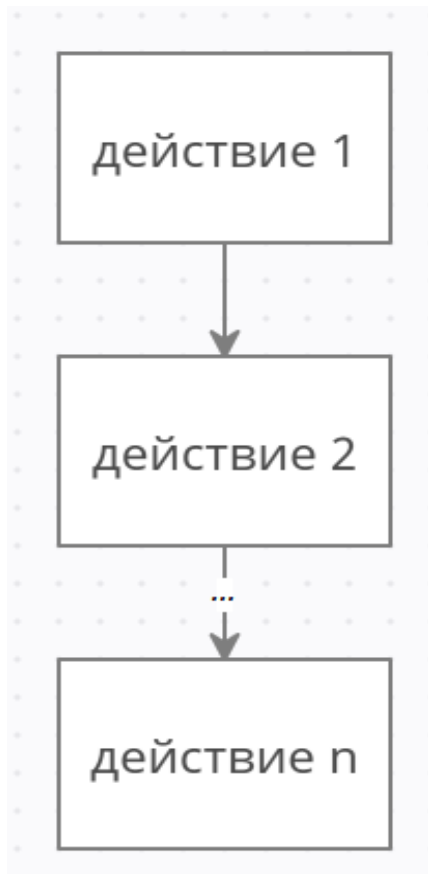
Рис. 107. Блок-схема линейного алгоритма
