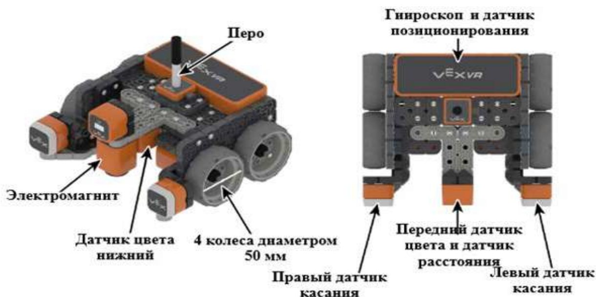
Рис. 7. Конфигурация датчиков робота
