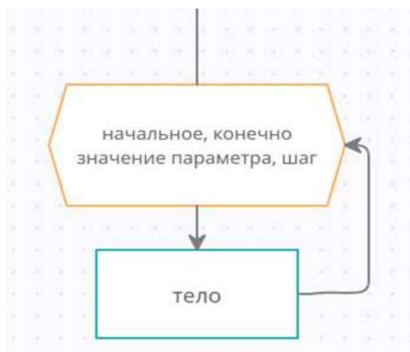
Рис. 58. Блок-схема цикла с параметром
